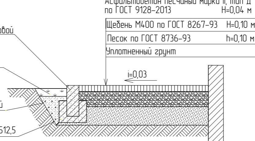
Конструкция отмостки шириной 1,00 м (ТД 52 с.2.110-1, вып.1)
