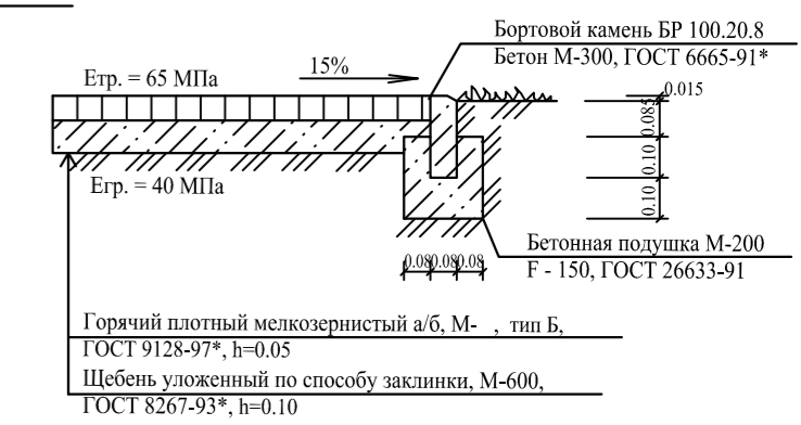
Тип 5 Конструкция тротуара с покрытием из а/б
