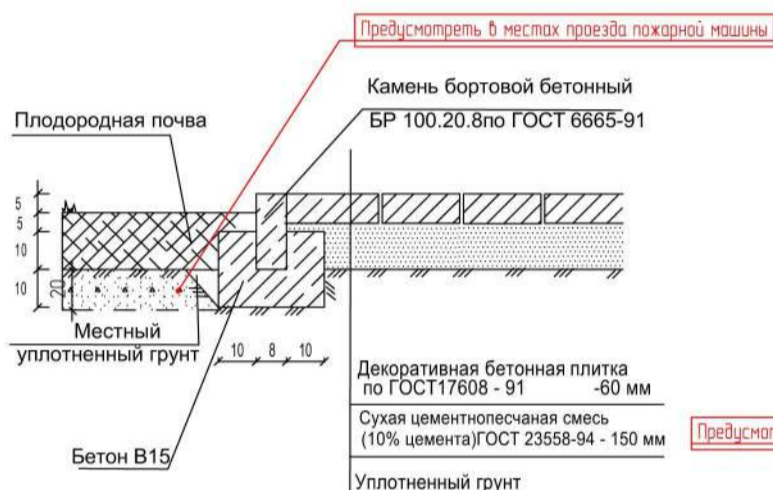
площадок и тротуаров с покрытием из декоративной плитки на цементно-песчанной смеси
