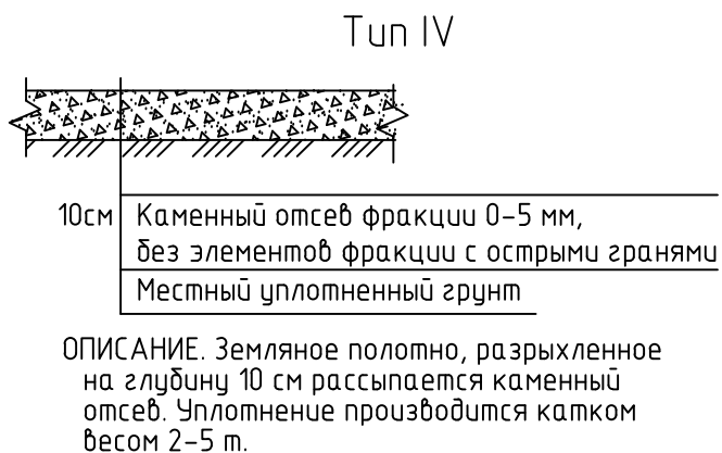
Конструкция хозплощадки, площадки для взрослых, детской площадки
