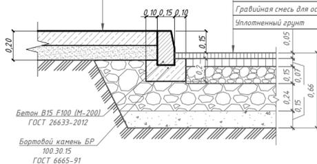
Бетонное покрытие площадок (тип V)
