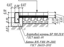
4) Сопряжение асфальтобетонного проезда и бетонной площадки
