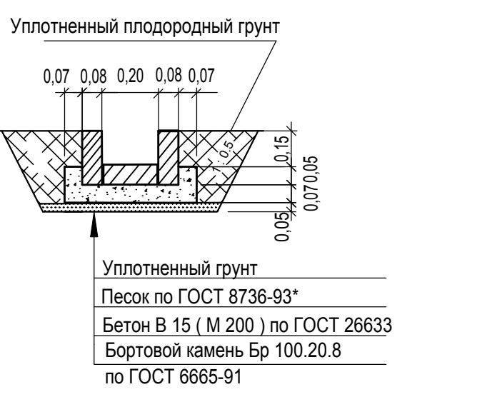
Водоотводный лоток тип 2 М 1 : 20
