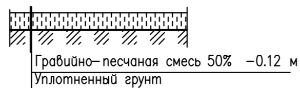
конструкция покрытия детских и физкультурных площадок
