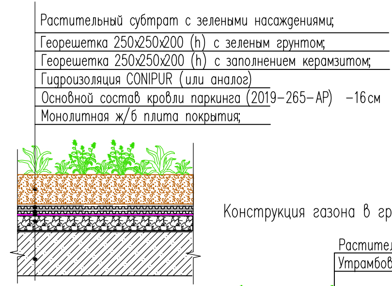
Конструкция газона над гаражом (Тип 6)
