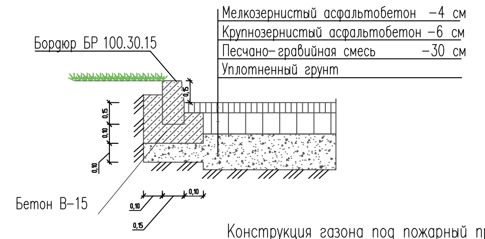
Конструкция газона в границах благоустройства (Тип 6а)
