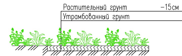
Конструкция газона в границах благоустройства (Тип 6а)
