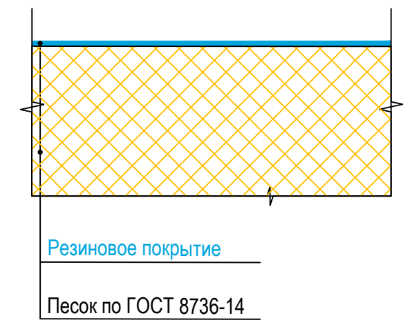
Конструкция дорожной одежды Тип Б
