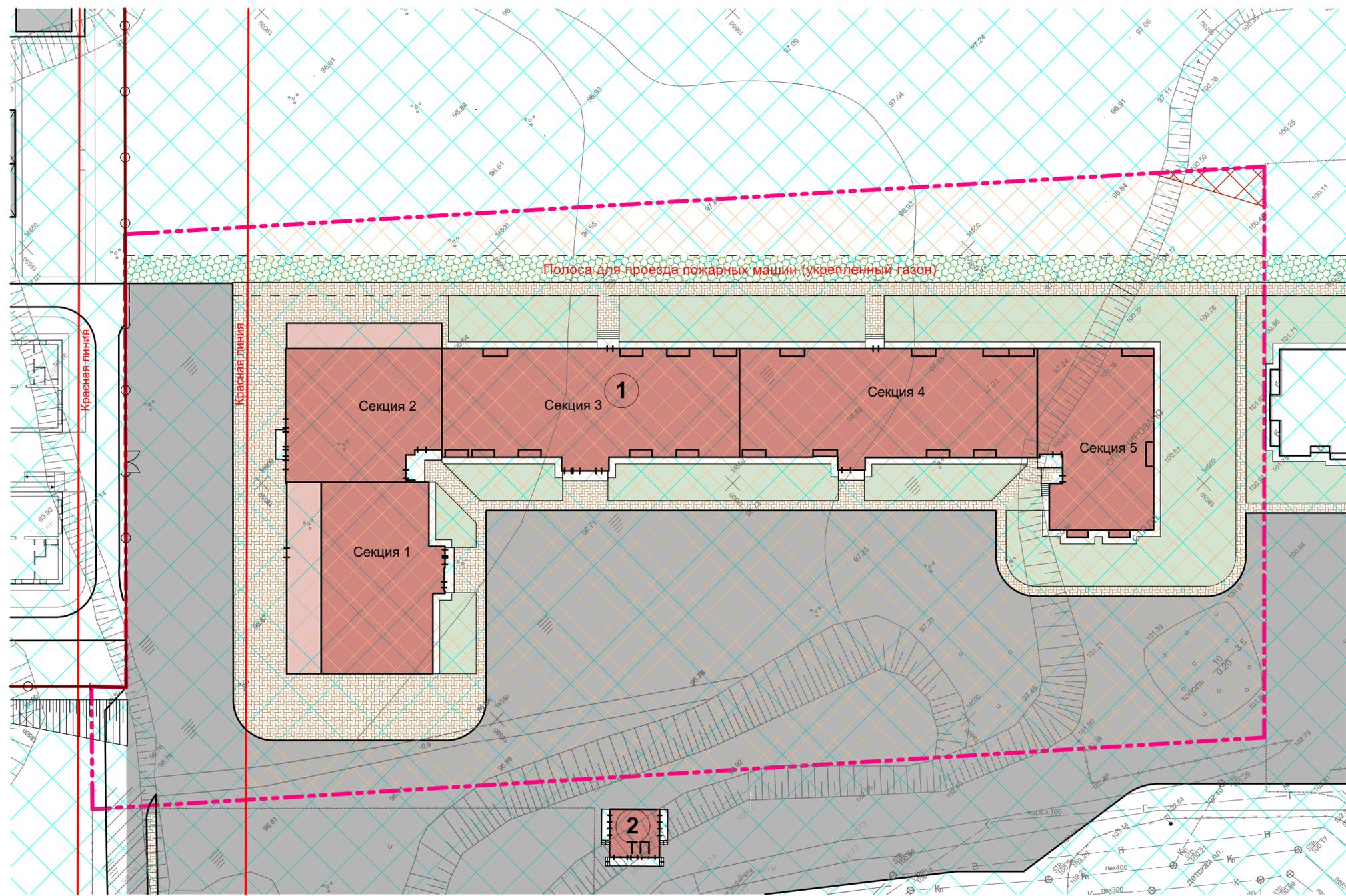
Полоса для проезда пожарных машин (укрепленный газон)
