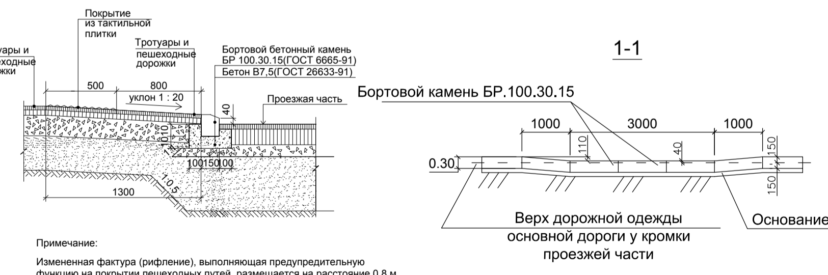
Узел А. Примыкание проезжей части с тротуаром в зоне устройства тактильной плитки и пониженного борта
