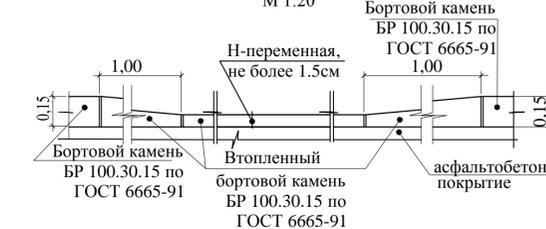
**ДЕТАЛЬ УСТРОЙСТВА ВТОПЛЕННОГО БОРТОВОГО КАМНЯ НА ТРОТУАРАХ. М 1: 20**
