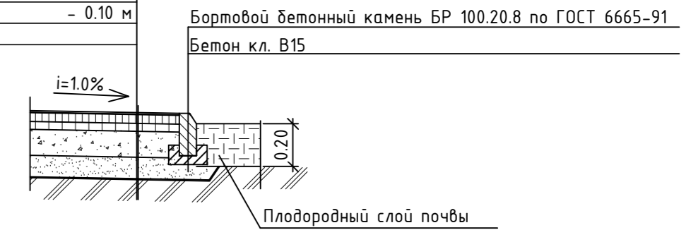
КОНСТРУКЦИЯ ПОКРЫТИЯ ХОЗЯЙСТВЕННОЙ ПЛОЩАДКИ тип 4
