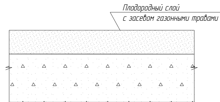
Конструкция пожарного проезда с щеденочным основанием
