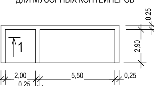
ОГРАЖДЕНИЕ ПЛОЩАДКИ ДЛЯ МУСОРНЫХ КОНТЕЙНЕРОВ
