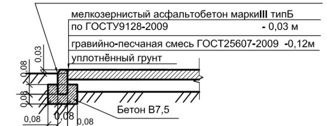
КОНСТРУКЦИЯ ПОКРЫТИЯ ПЛИТКОЙ, Тип III
