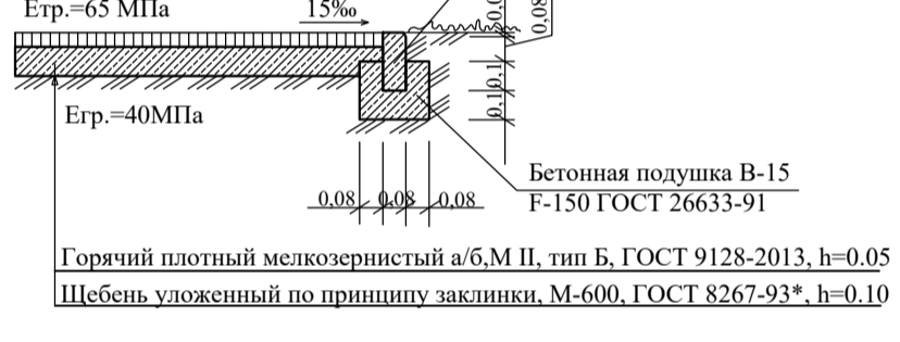
Конструкция покрытия тротуара с возможностью проезда ТИП-3
