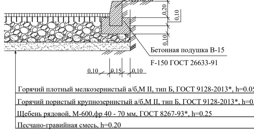
Конструкция тротуара с покрытием из а/б ТИП -2
