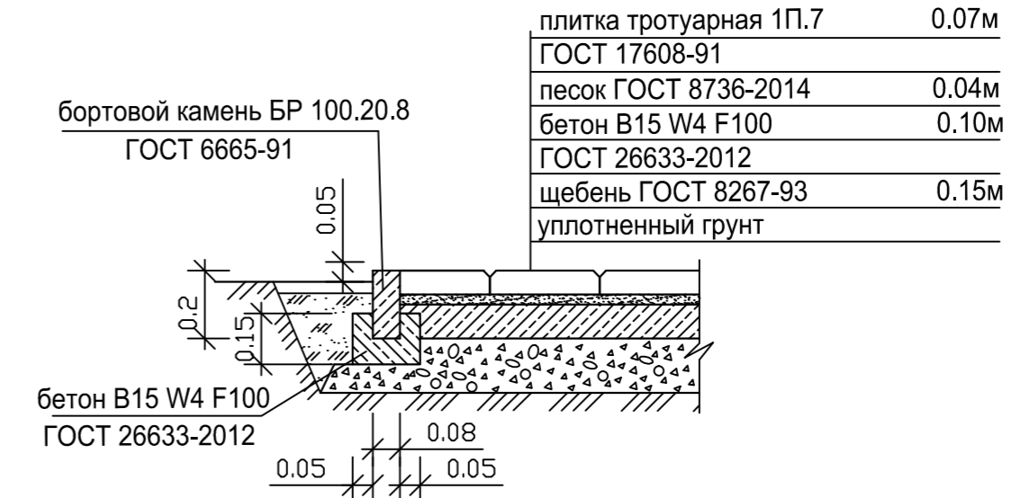
тротуаров, отмостки тип II
